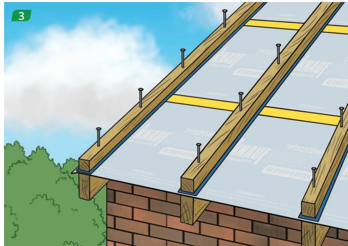
Проклеиваем мембрану вдоль стропил уплотнительной лентой. Устанавливаем сверху прижимной брускок и фиксируем его.
