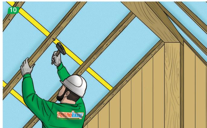
Поверх пароизоляции устанавливаем вертикальную обрешетку и фиксируем ее.
