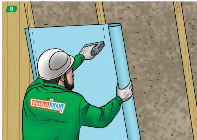
Раскатываем мембрану горизонтально вдоль нижней части стропил с заходом на стену и фиксируем степлером. Каждый последующий слой - выше предыдущего, нахлест в 10-15 см. Стыковка мембранны - только по стропилам. Стыковка мембранны в районе конька - внахлест.
